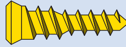
Selbstschneidend mit Verblockung Self-tapping with locking Autoroscante con blocco Autotaraudeuse avec blocage Autofilettante con bloccaggio
